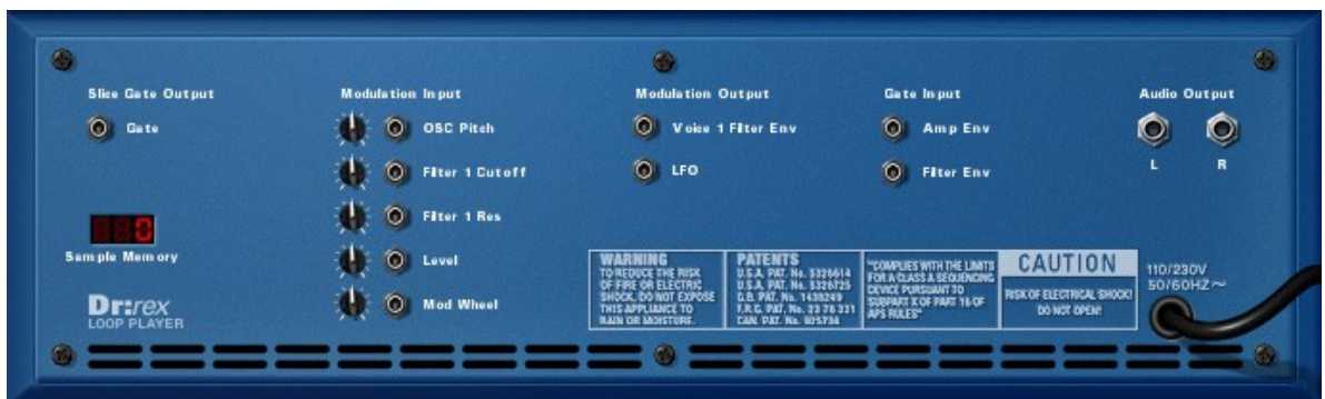
Рис. 4.15. Задняя панель REX
