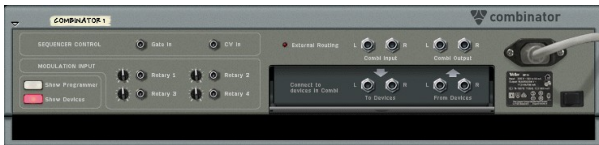
Рис. 4.64. Задняя панель Combinator (включен режим отображения Show Devices )
