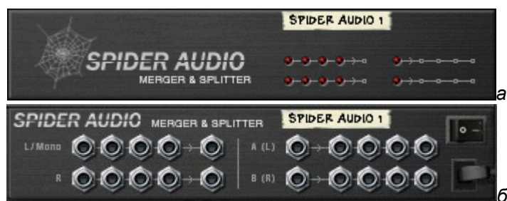
Рис. 4.53. Передняя (а) и задняя (б) панель SPIDER AUDIO
