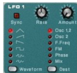
Рис. 4.31. Параметры первого генератора низкочастотных сигналов
