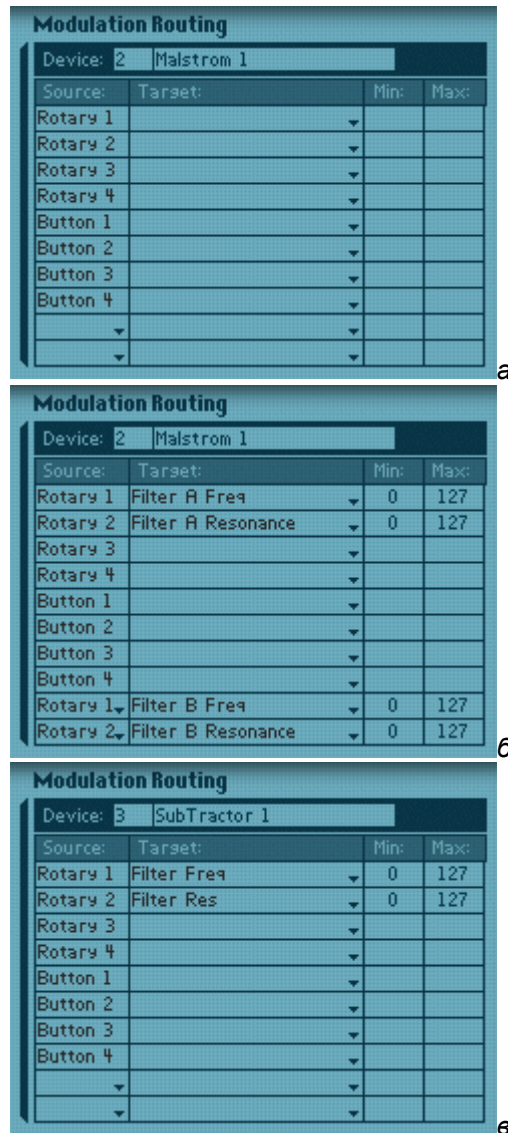
Рис. 4.63. Редактирование связей между назначаемыми регуляторами Combinator и параметрами синтеза подчиненных устройств
