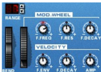
Рис. 4.13. Регуляторы коэффициентов зависимости, определяющих реакцию колеса модуляции на значение параметра Velocity
