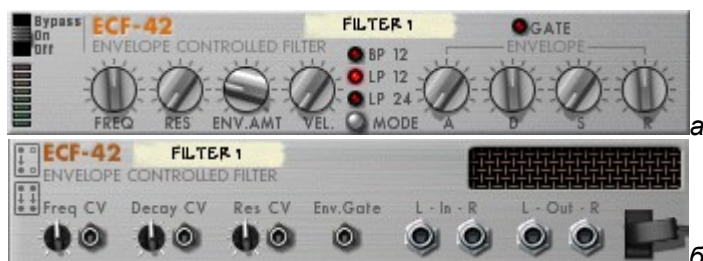
Рис. 5.5. Передняя (а) и задняя (б) панели ECF-42
